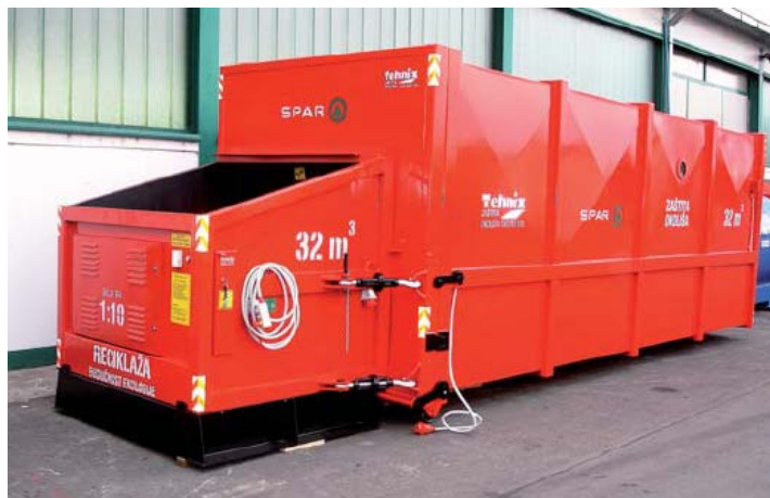
Слика 6.4. Пример једног пресконтејнера од 32 m 3
